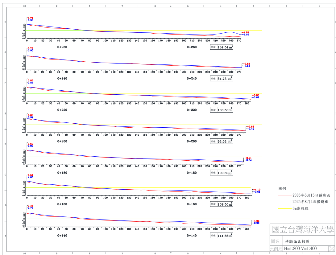
圖 4-5(e) 2025 年 8 月 4 日 B 監測區橫断面比較圖
