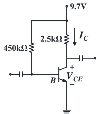
[A] 28. 若一個雙極性電晶體(BJT)在主動區操作模式下，射極電流為 4.05 mA，基極電流為 0.05 mA，則其  $\beta$  值為何？
