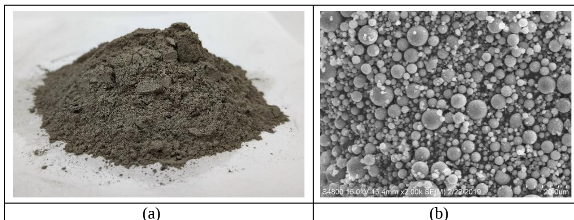
圖 2-2 飛灰((a)外觀圖(b)微觀圖(2000X))(台電內部資料)
