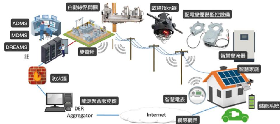
註：1. 先進型配電管理系統 (Advanced Distribution Management System, ADMS)
