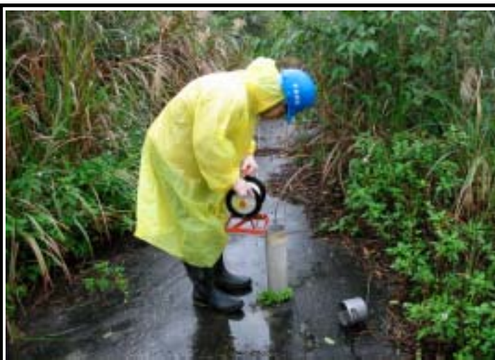
照片2-1 地下水水位量測情形
